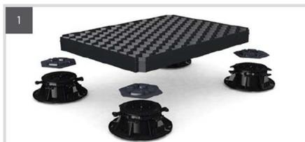
Platzieren Sie die TRIAS WABIC Stellfüße für das erste Board an den jeweiligen Eckpositionen und setzen Sie die TRIAS WABIC Add-On-Adapter ein. Stellen Sie die Stellfüße auf die gewünschte Höhe ein. Bei angrenzenden Wänden und Mauern setzen Sie die Stellfüße entsprechend dem Wabenraster nach innen.
