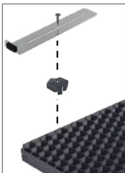
Für den Randabschluss steht Ihnen der TRIAS WABIC Plattenanschlag zur Verfügung, welcher auf TRIAS WABIC FIX-CLIP montiert wird.
